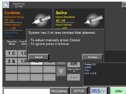
(2) ARM모드에서 인젝터 시스템은 프로그래밍 된 파라미터를 다시 보여준다. 인젝터 컨트롤러 또는 리모트 컨트롤에서 RUN버튼이나 팬던트 스위치를 누르면 주입이 시작되며 스크린에 표시된다. 주입이 시작된 경우, 경과시간이 분과 초단위로 표시된다. 메인 스크린으로 돌아올 때는 STOP버튼을 누르고, 주입을 재개하기 위해서는 RUN 버튼을 누른다. 리모트 컨트롤의 초록색 위, 아래 버튼이나, 인젝터 컨트롤러의 +, \_ 버튼을 이용하여 작동 중 현재 진행 중인 단계의 유속(flow rate)을 조절할 수 있다. 수동으로 유속을 조절할 경우 주의해서 사용하도록 한다. 인젝터에서 주입하는 동안 지속적으로 업데이트 되는 주사기 압력(syringe pressure)를 표시한다. 높은 유속과 낮은 압력 제한(pressure limit) 값이 동시에 선택되거나, 주사액 경로가 막힌 경우 압력 제한 및 과압 메시지가 발생할 수 있다.
