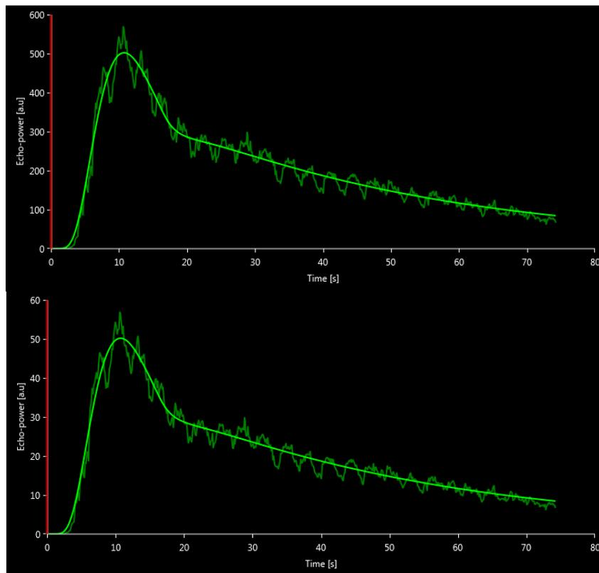
**Figura 16 - Ejemplo de señales antes y después de la compensación de ganancia. En este caso, necesitamos compensar una ganancia de 10 dB, por lo que hay que aplicar una compensación de +10 dB. Por ello la amplitud de la señal al final se multiplica por 0,1 ( $10^{-Gain/10}$ ).**
