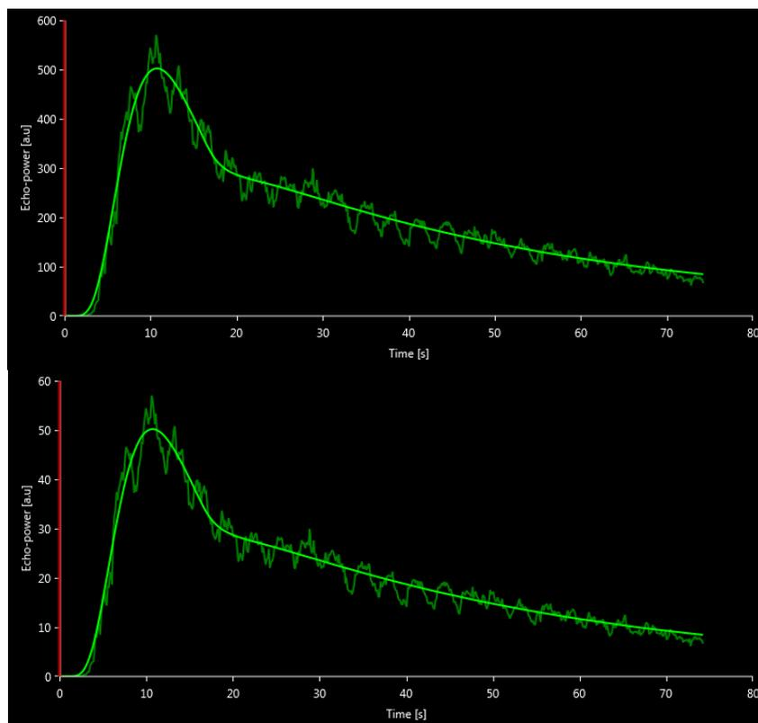
**Figura 16 – Esempio di segnali prima e dopo la compensazione del guadagno. In tal caso, è stato necessario applicare una compensazione di +10 dB per ottenere un guadagno di 10 dB. Pertanto, l'ampiezza del segnale alla fine viene moltiplicata per 0,1 ( $10^{-Gain/10}$ ).**
